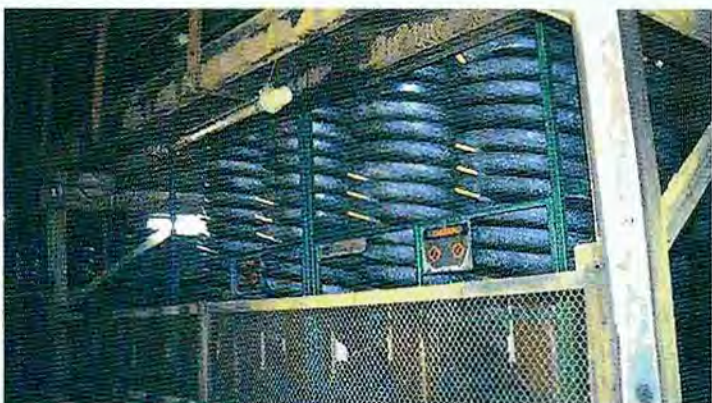
Реконструкция узла дешламации и внедрение схемы спиральных сепараторов на ЦОФ "Печорская" позволили значительно сократить расходы флотационных реагентов и магнетита.
