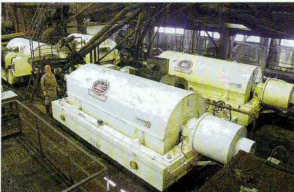
Применение центрифуг "Декантер" на ЦОФ "Кузбасская" позволило значительно снизить себестоимость процесса обогащения.
