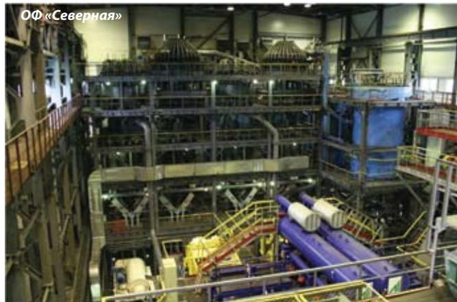
Раздельная флотация тонких шламов классов 0-0,04 мм и 0,04-0,15 мм, обусловлена работой фабрики по летнему и зимнему режимам. Флотация класса 0-0,04 мм предусмотрена только в летний период по условию сезонного ограничения влажности общего концентрата.
