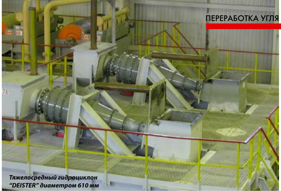
**Тяжелосредний гидроциклон "DEISTER" диаметром 610 мм**
