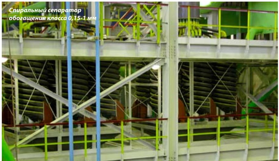
**Спиральный сепаратор обогащения класса 0,15-1 мм**
