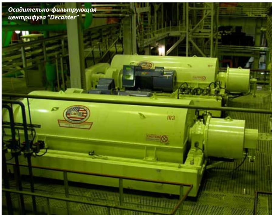
Осадительно-фильтрующая центрифуга «Decanter»
