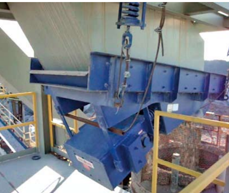
Рис. 8. Вибрационный питатель Jeffrey Rader в условиях круглосуточной работы дробильного комплекса на известняковом карьере. Южная Каролина, США
