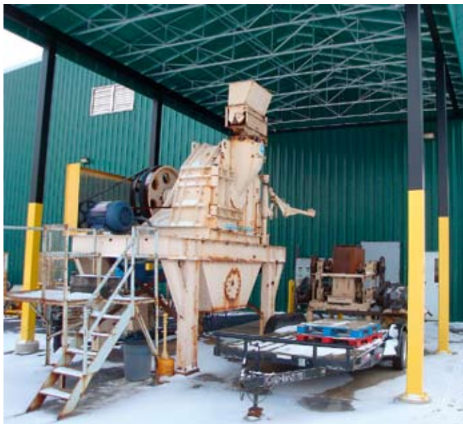
Рис. 4. Машины для проведения тестов на материалах заказчиков — дезинтегратор Cage Paktor 50B и двухвалковая дробилка Roll Crusher серии 2000. Территория завода Gundlach, Белльвилль, Иллинойс
