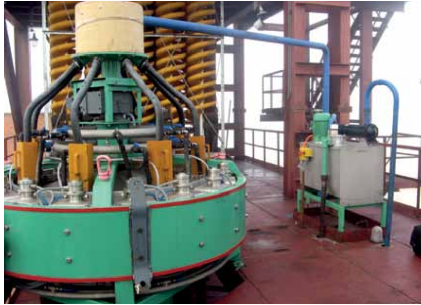
Рис. 5. Технологическая линия гравитационно-магнитного дообогащения хвостов руд.
