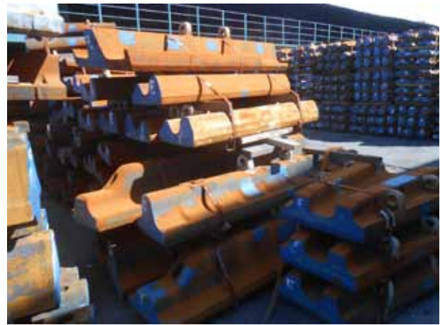
Рис. 9. Мельничные футеровки из хром-молибденовой стали на складе.
