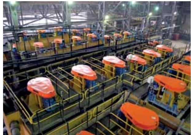
Рис. 7. Отделение механической флотации полиметаллических руд.
