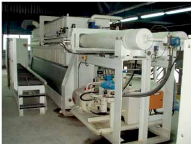
Рис. 8. Камерный фильтр-пресс для фильтрации минерального сырья.
