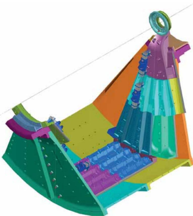
Рис. 6. 3D-модель мельницы МПСИ (вид на барабан и торец разгрузки).
