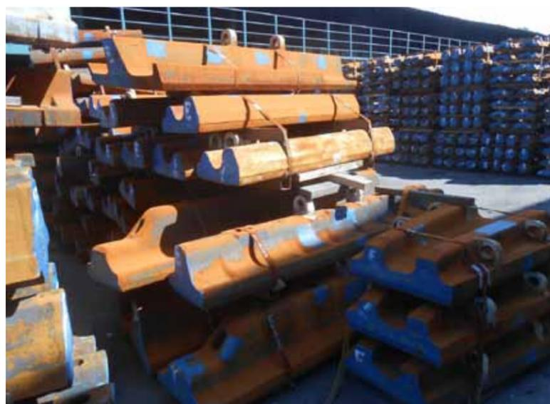
Рис. 1. Футеровка из хром-молибденовой стали на складе компании «PT Growth Asia».
