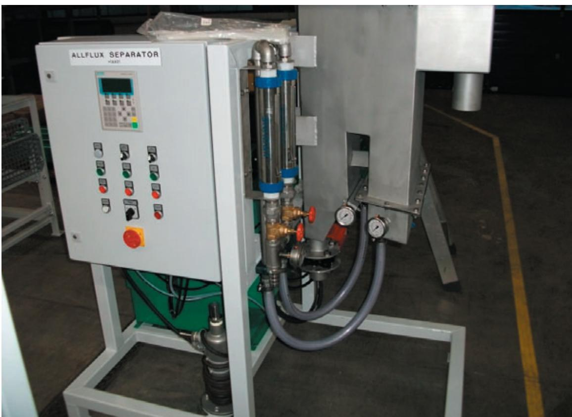
гематитовых руд в рамках как лабораторных, так и полу-промышленных испытаний на пилотной модели гидравлического сепаратора allflux. (рис. 6). После получения положительных результатов данных тестов, заказчику были предложены промышленные модели гидравлических сепараторов с гарантированным получением требуемого качества конечного продукта.
