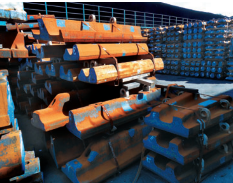
РИС. 1. Футеровка из хром-молибденовой стали на складе компании «PT Growth Asia»
