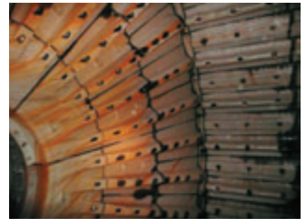
РИС. 2. Футеровка компании «PT Growth Asia» работающая в мельнице диаметром 12 метров
