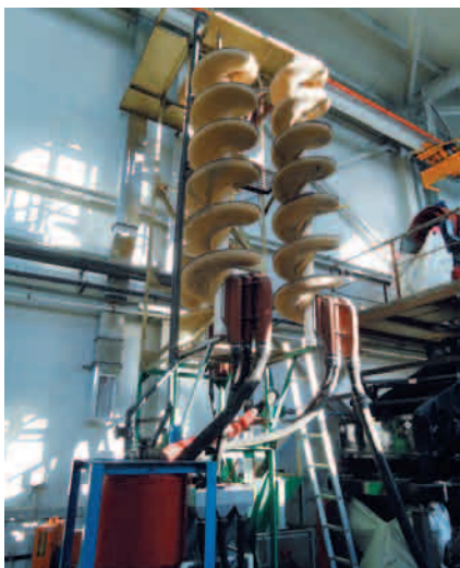
РИС. 5. Спиральные сепараторы MG6.3 и HG10i
